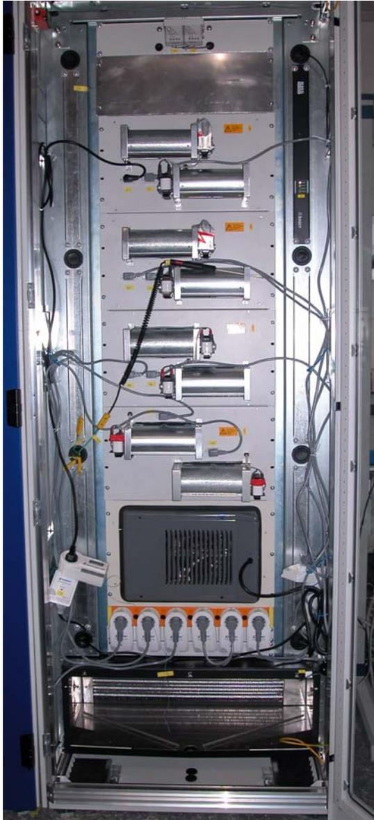
**Bild 13: Frontseite des getesteten Schrankes mit acht Heizregistern zu je 2 kW**
