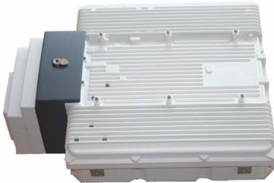
Abb. 3: Der Fokus von OpenBSC liegt auf der GSM-Infrastruktur. Es setzt dazu neben anderem auf die Originalhardware von Siemens (BS-11), die Ende der 1990er Jahre an Mobilfunkprovider vertrieben wurde.
