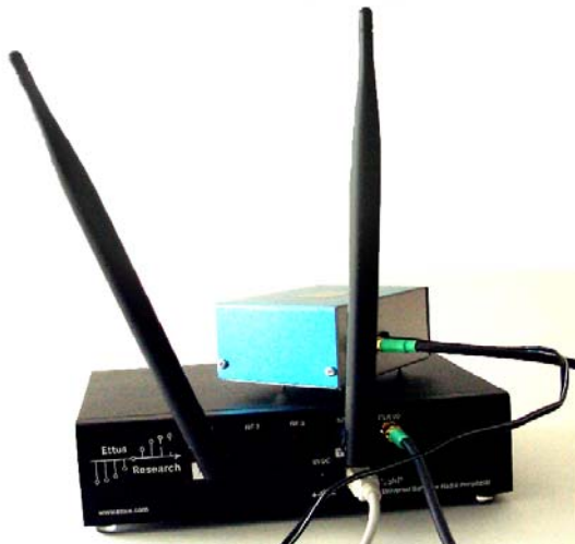
Abb. 2: Das USRP der Firma Ettus Research, das um einen externen Zeitgeber zur Verbesserung der Empfangs- und Sendegenauigkeit auf den GSM-Bändern ergänzt wurde.
