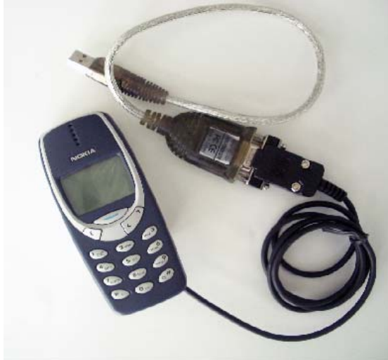
Abb. 9: Das Nokia 3310 mit DCT3 eignet sich für eine Reihe von Analysezwecken für das GSM Air-Interface. Die erzeugte Datenrate lässt sich gut via serieller Schnittstelle zum Computer übertragen.
