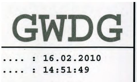
Abb. 2: Eine Schriftprobe des IRC 5030i; man beachte die homogenere Graustufendarstellung beim Schriftzug „GWDG“ im Vergleich zum CLC 3220 (siehe unten)
