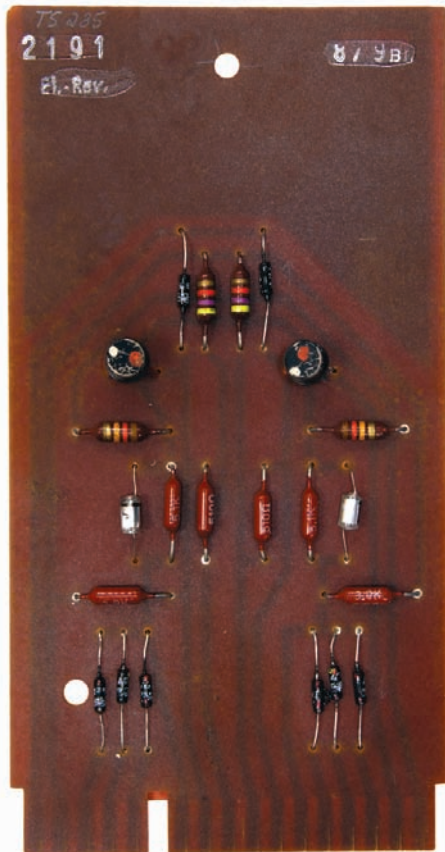
Abb. 22: Platine mit zwei ODER-Gattern mit je drei Eingängen in DTL
