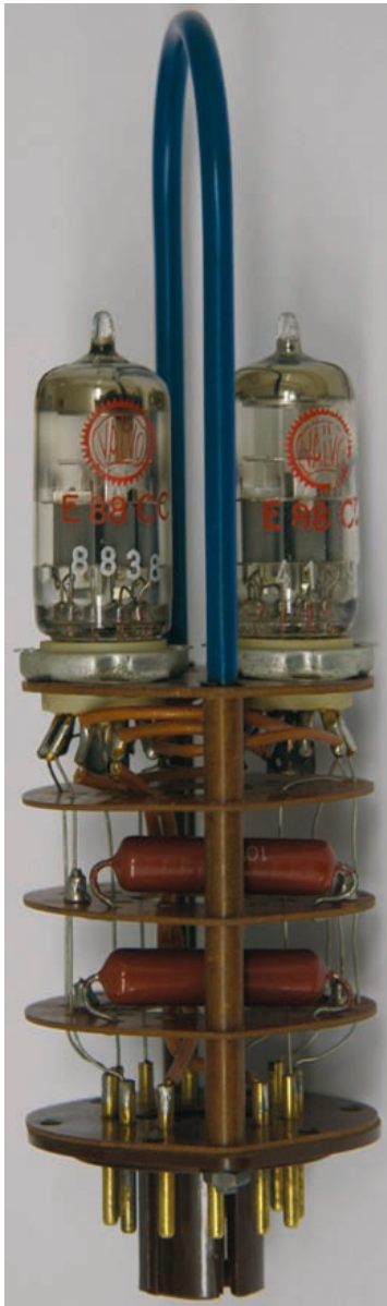
Abb. 18: Röhren-Steckbaugruppe mit zwei Röhren E88CC
