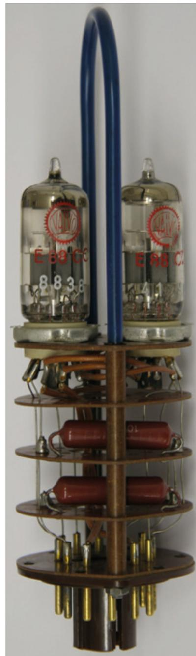
7 Röhrenbaugruppe aus der „Zuse Z22“ mit zwei Doppeltrioden E88CC
